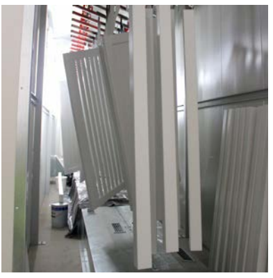
Painted products in drying chamber • Lackierte Produkte in der Trockenkammer • Les produits peints transitent par une chambre de séchage • Productos pintados en la cámara de secado • Prodotti verniciati in camera di essiccazione
