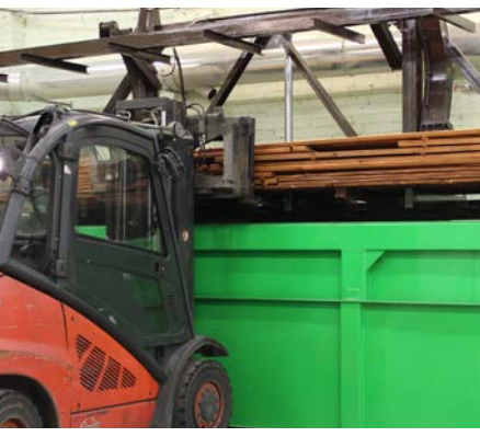
Treatment bath • Tauchanlage für Holzschutzmittel • Bain de traitement • Baño de tratamiento • Bagno di trattamento
