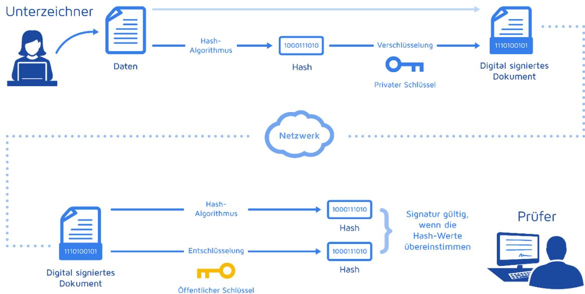
**Abbildung 14:** Schema der Funktionsweise von digitalen Signaturen
