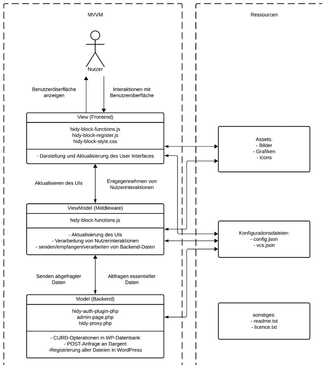
**Abbildung 24:** Softwarearchitektur des Validierungs-Plug-ins nach MVVM-Muster
