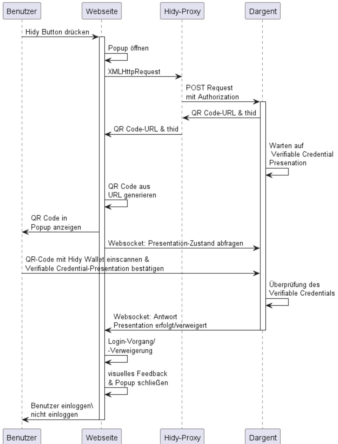
**Abbildung 23:** Sequenzdiagramm des Validierungsprozesses
