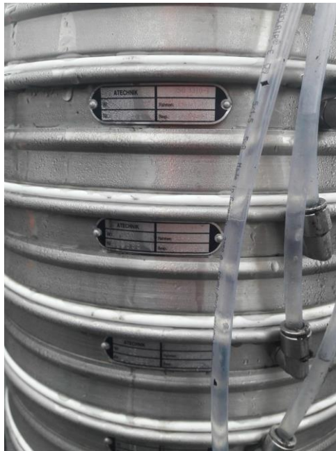
Abbildung 33: Entlüftungsschläuche, hier verwendet zur Pegelmessung beim Überstauen des Probenahmekorbs
