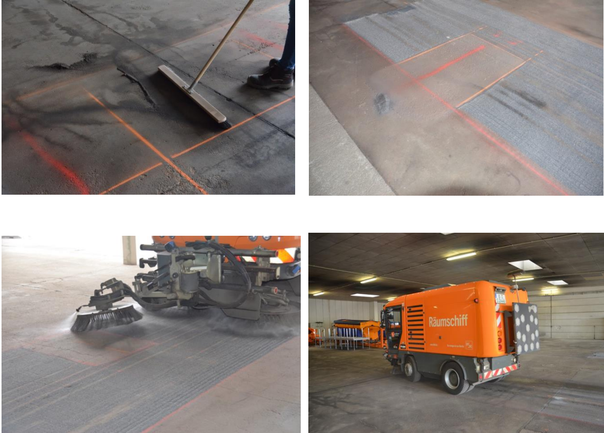
Abbildung 84: Fotodokumentation des ersten Kehrversuchs in der Halle zur Ermittlung der Kehreffizienz von Reifenantrieb
