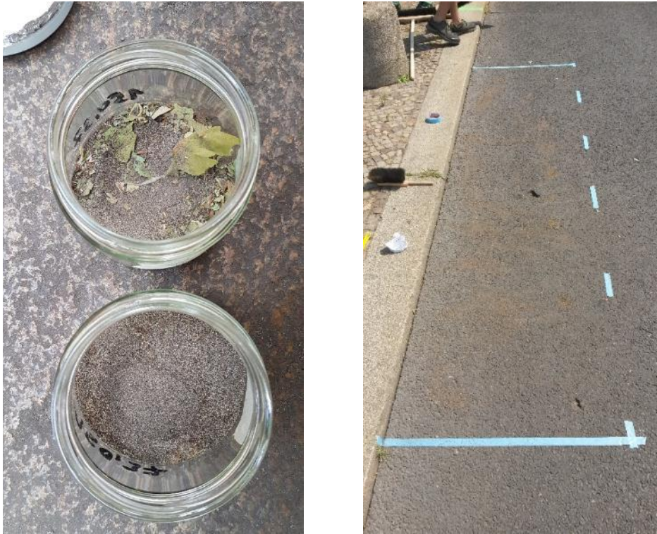
Abbildung 27: Prüfstoffmischung in Gläsern vor (unten) und nach (oben) dem Ausbringen und Vorgehen für die WF-Versuche (rechts)
