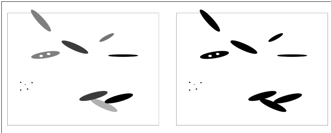
Abbildung 49: Prinzipskizze, Konvertierung von einem Grauwertbild in ein binäres Bild mittels adaptivem Schwellwertverfahren
