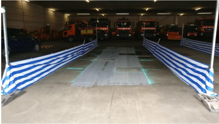
Abbildung 86: Testfeld zur Ermittlung der Reinigungseffizienz von Kehrfahrzeugen - 2. Versuch
