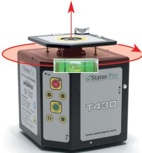
Wenn der T430 in stehender Position aufgebaut ist, wird er zunächst mit seiner Horizontal-Dosenlibelle vorjustiert. Wenn daraufhin der Nivellier-Button gedrückt wird, wird die rotierende Laserebene vollautomatisch nivelliert, der stehende Laserstrahl steht dann lotrecht.
