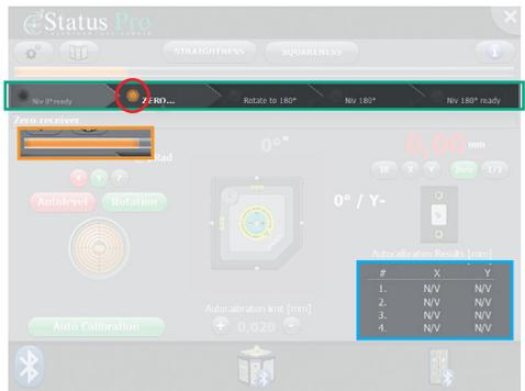
Nun muss lediglich noch der Auto Calibration-Button **Auto Calibration** gedrückt werden und der Kalibrierungsvorgang des Rotationslasers startet automatisch für Sie.
