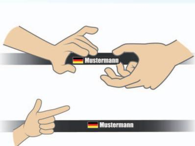
Nach dem Positionieren und Auflegen der Aufkleber, können Sie diese auf der Oberfläche andrücken und die Luft zur Seite "rausschieben".
