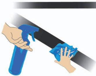
Reinigen Sie den Untergrund mit Wasser und einem Tuch. Bei groben Verschmutzungen oder Fetten und Ölen können Sie spezielle Reinigungsmittel wie z.B. Mellerud Kleberreste-entferner nutzen.
